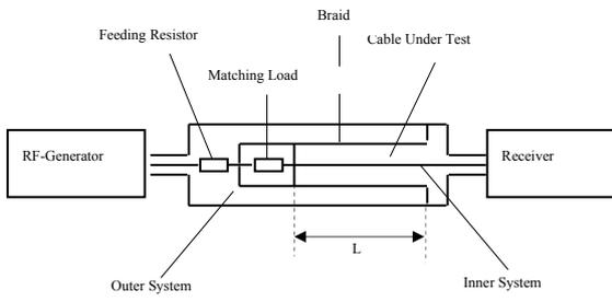
FIGURE 1 TRIAXIAL TEST SET UP
